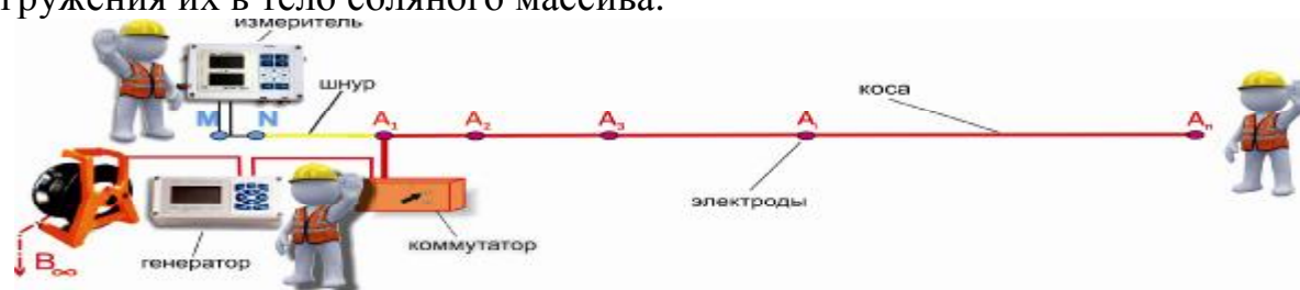
Рис. 1. Система многоэлектродных наблюдений для проведения экспресс-зондирования околоштрекового пространства
